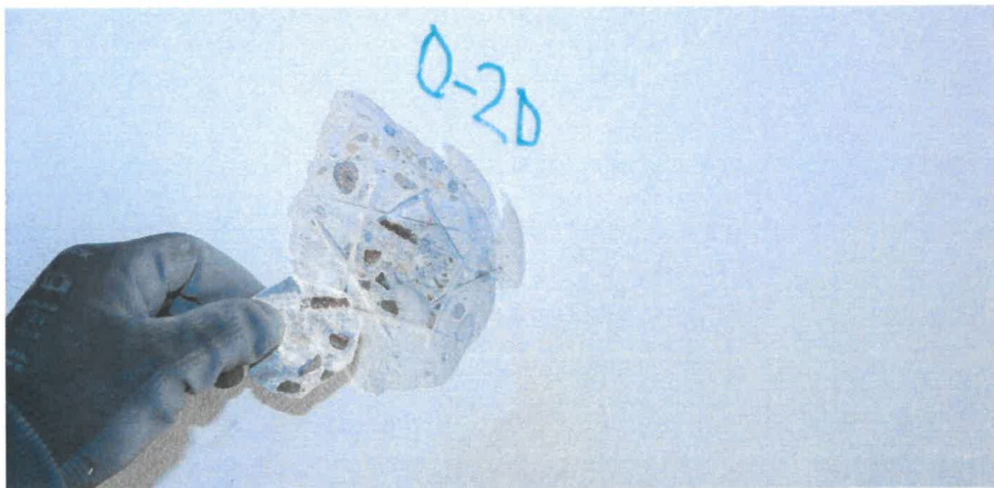
Obr. 21: Pohled na zkušební místo O-2D – odtrhová zkouška na spodním líci stropní desky 1.NP.
