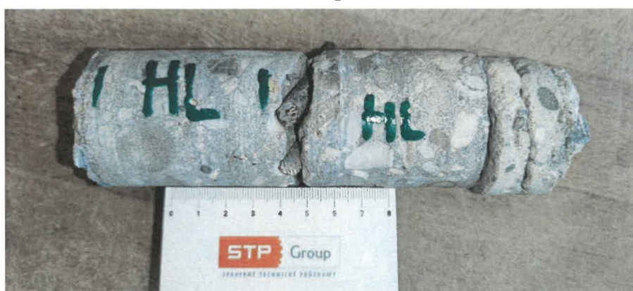
Obr. 31: Pohled na jádrový vývrt HL, který byl odebrán z roznášecí předpjaté hlavice vnitřního sloupu parkoviště (v místě sondy SS3).
