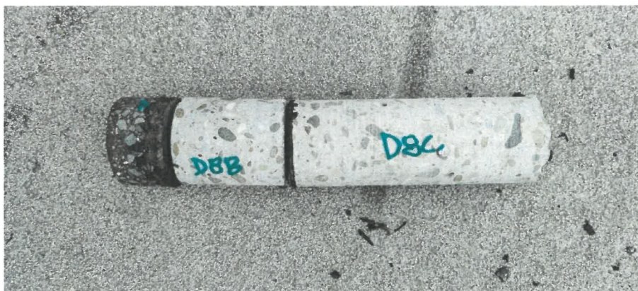
Obr. 13: Pohled na jádrový vývrt D8, který byl odebrán přes vozovkové souvrství parkoviště 3. NP.
