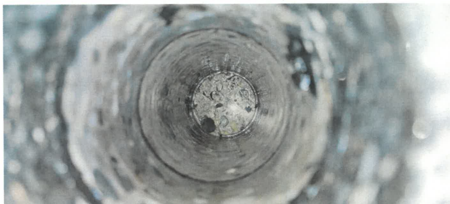
Obr. 2: Pohled do sondy po odběru jádrového vývrtu D1, který byl odebrán přes vozovkové souvrství parkoviště 2. NP.
