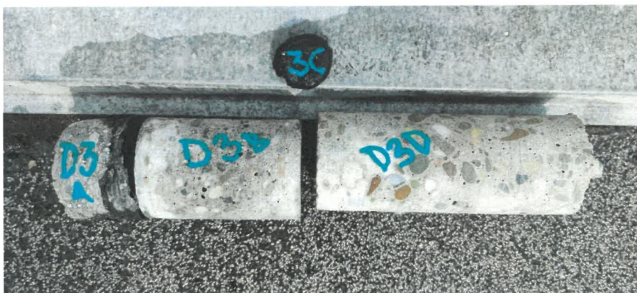
Obr. 5: Pohled na jádrový vývrt D3, který byl odebrán přes vozovkové souvrství parkoviště 2. NP.
