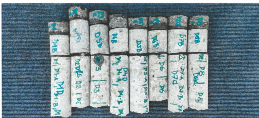
Obr. 30: Pohled na jádrové vývrty D1 až D8, které byly odebrány přes vozkovou souvrstí 2. NP a 3.NP parkoviště.
