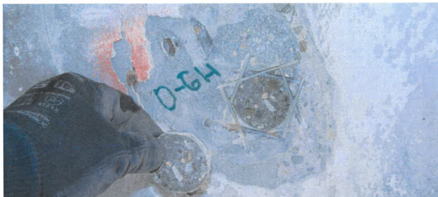
Obr. 22: Pohled na zkušební místo O-6H – odtrhová zkouška na spodním líci roznášecí hlavice sloupu (po odstranění sanačního souvrství),
