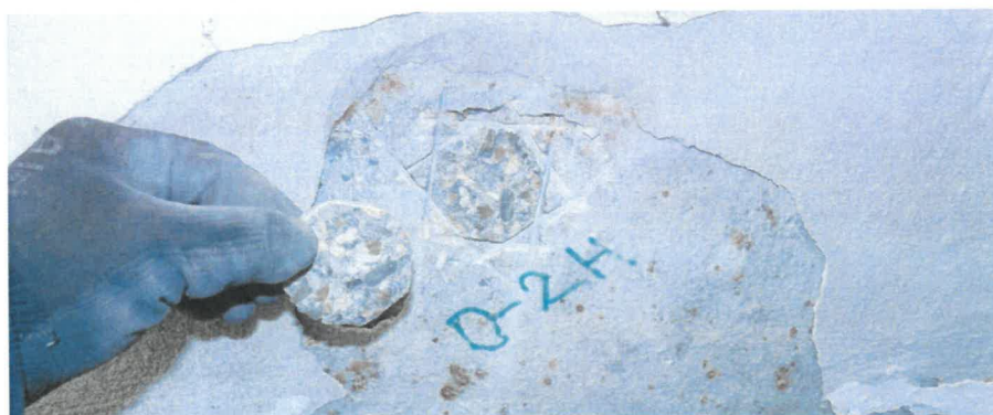
Obr. 20: Pohled na zkušební místo O-2H – odtrhová zkouška na spodním líci roznášecí hlavice sloupu (po odstranění sanačního souvrství).
