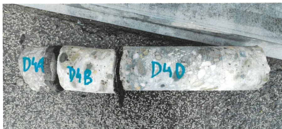
Obr. 7: Pohled na jádrový vývrt D4, který byl odebrán přes vozovkové souvrství parkoviště 2. NP.
