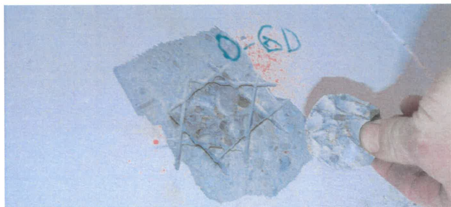
Obr. 23: Pohled na zkušební místo O-6D – odtrhová zkouška na spodním líci stropní desky 1.NP.
