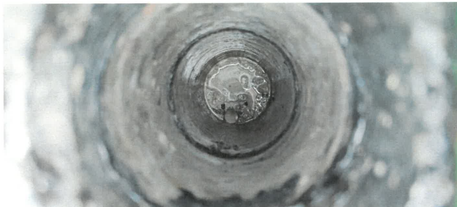
Obr. 6: Pohled do sondy po odběru jádrového vývrtu D3, který byl odebrán přes vozovkové souvrství parkoviště 2. NP.
