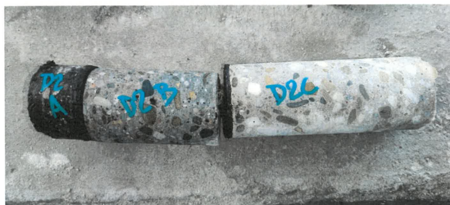
Obr. 3: Pohled na jádrový vývrt D2, který byl odebrán přes vozovkové souvrství parkoviště 2. NP.
