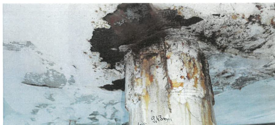
Obr. 28: Zkušební místo 4/C-1. NP – měření tloušťky roznášecí desky pod předpjatou hlavicí sloupu – 9,43 mm.
