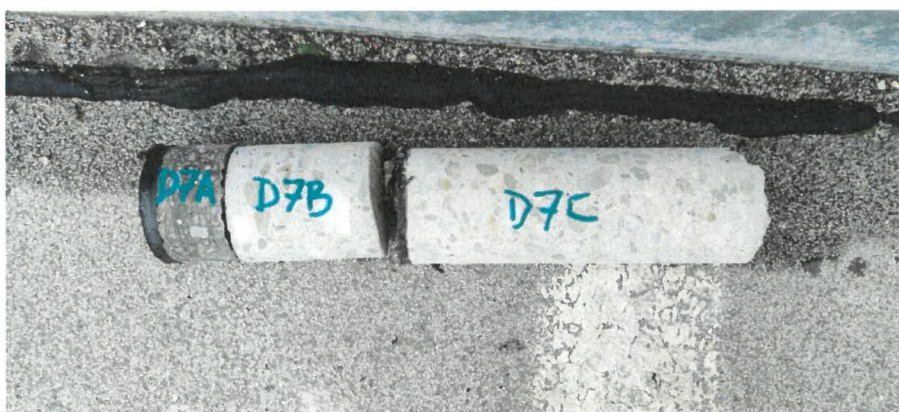
Obr. 11: Pohled na jádrový vývrt D7, který byl odebrán přes vozovkové souvrství parkoviště 3. NP.
