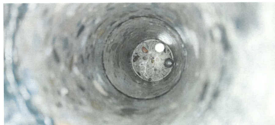
Obr. 4: Pohled do sondy po odběru jádrového vývrtu D2, který byl odebrán přes vozovkové souvrství parkoviště 2. NP.
