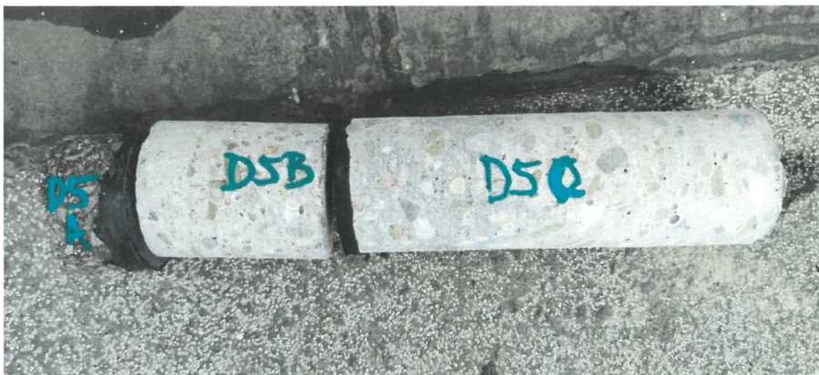
Obr. 9: Pohled na jádrový vývrt D5, který byl odebrán přes vozovkové souvrství parkoviště 3. NP.
