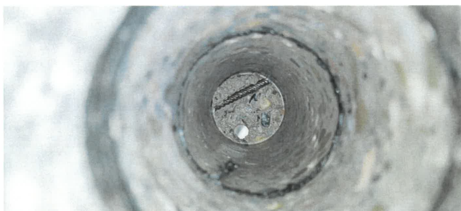
Obr. 12: Pohled do sondy po odběru jádrového vývrtu D7, který byl odebrán přes vozovkové souvrství parkoviště 3. NP.
